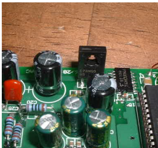
図 レギュレータの向き（型番が書いてあるほうが基板内側へ）
