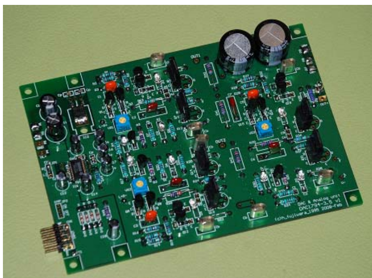
完成例 DAC1794-3.5 Bタイプ (DAC&アナログ基板)
