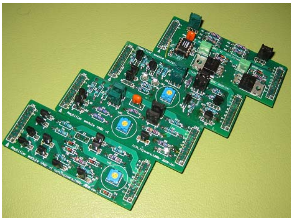
(b)ドータボード: 電圧増幅アンプ群(左下から A6,A8,A11,OPA 基板)
