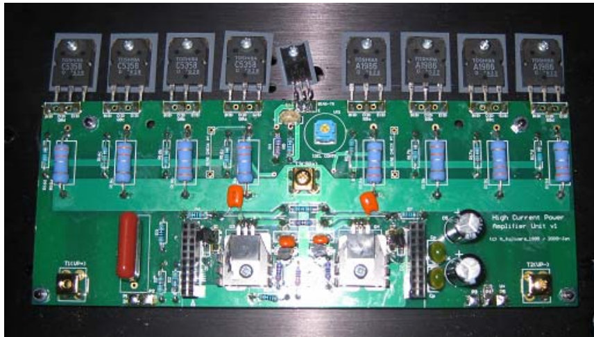
トランジスタを取り付けた状態(中央のトランジスタはバイアス電圧発生用) 図 完成例
