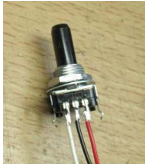
図 ロータリーエンコーダの接続例 (プルアップ抵抗にチップ抵抗を使用した場合)
