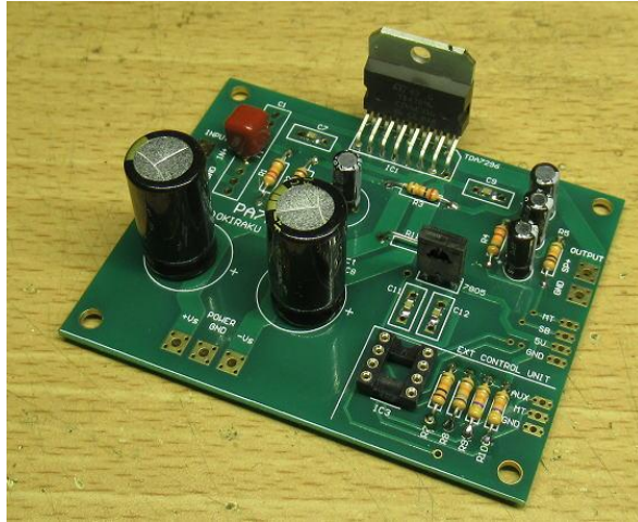
図 完成例 (制御マイコンは未搭載)
