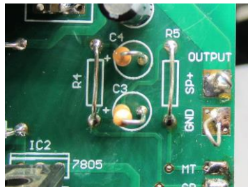
図 実装例（C3, C4 に抵抗器、R4, R5 はジャンパー）
