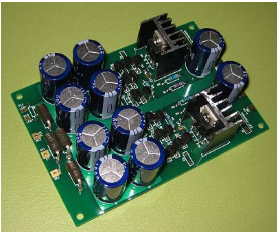
平滑コンデンサ付き正負出力定電圧電源基板
