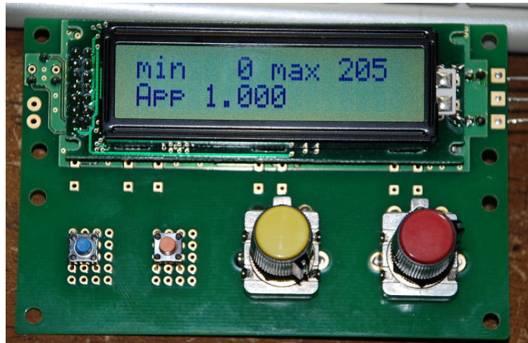
図 内部 AD を用いた校正の様子
