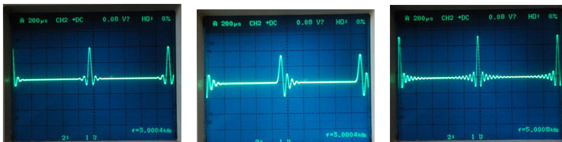
図 DAC8741 ではフィルター応答が選択可能です（パルス入力時の応答波形例）
