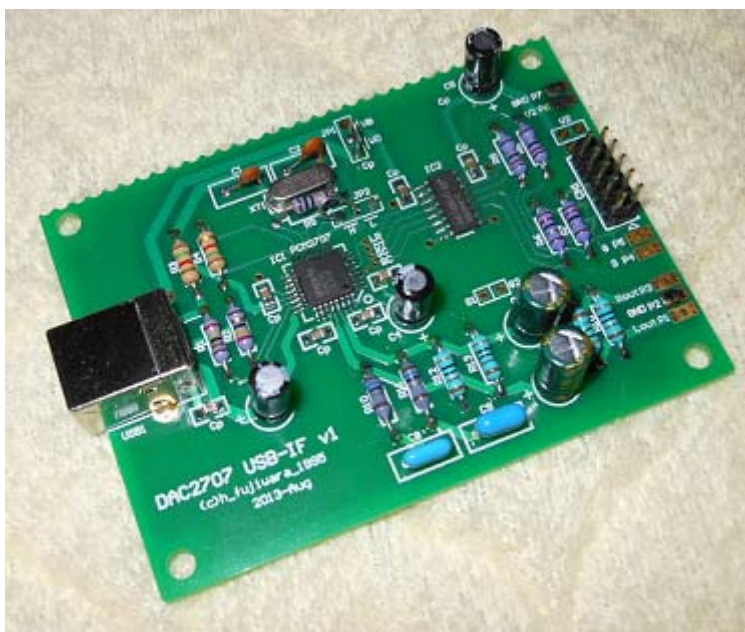
図 完成例 (デジタルバッファーに Si8440 を使用したバージョン)
