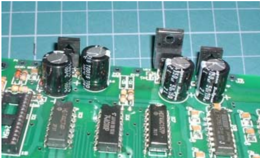
図 レギュレータの向き（型番が書いてあるほうが基板内側へ）
