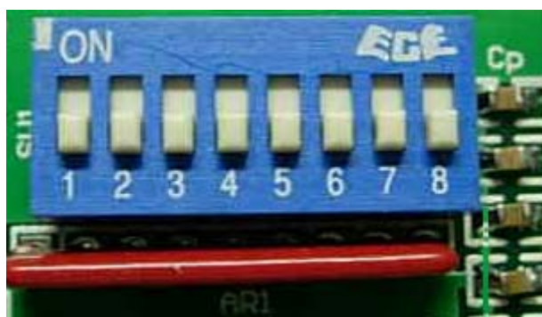
図 コントロール基板の DIP スwitch (CPU 下側)
