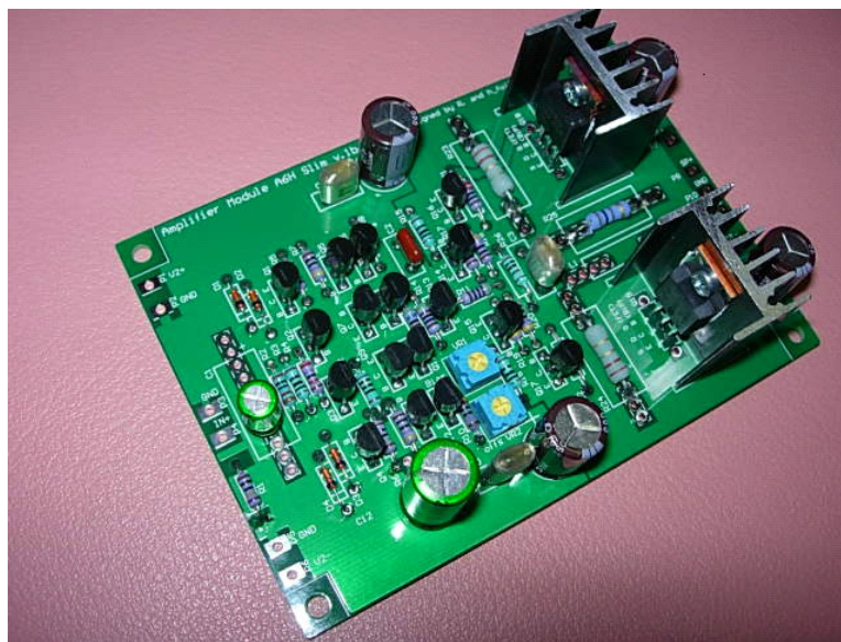
図 完成例（ヘッドホンアンプ）（*）Q16, 17の向き間違っています
